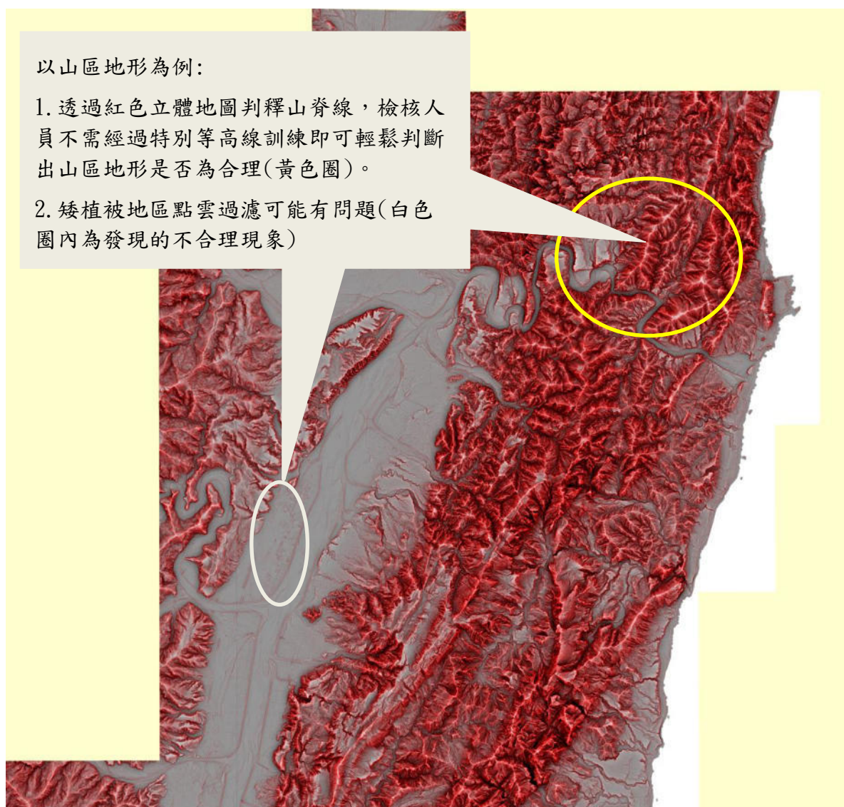
圖 3- 15 利用紅色立體地圖檢視 DEM 成果品質圖
