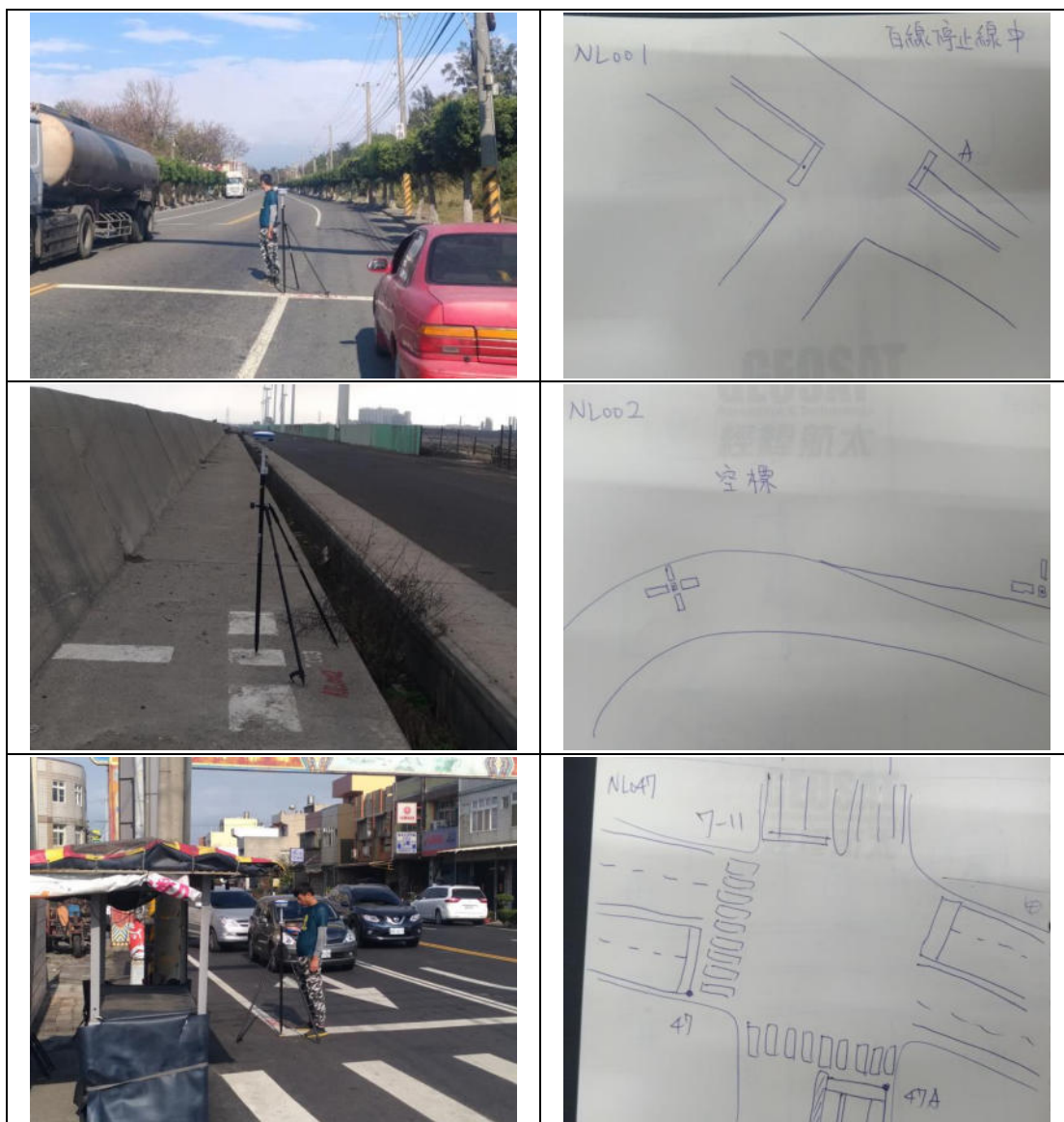
圖 3-10 108 年 2 月 15 日完成航測控制與檢核點測量照片
