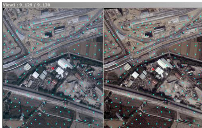
圖 3-3 人工修測 DEM 高程展點圖（紅點為浮測標位置）
