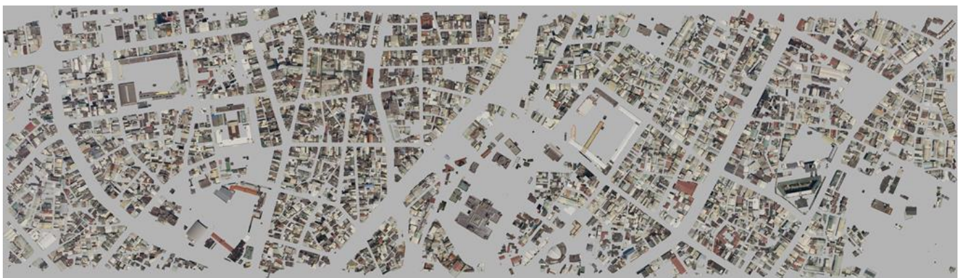
圖 3-11 屋頂真實正射影像範例(臺中市豐原區)
