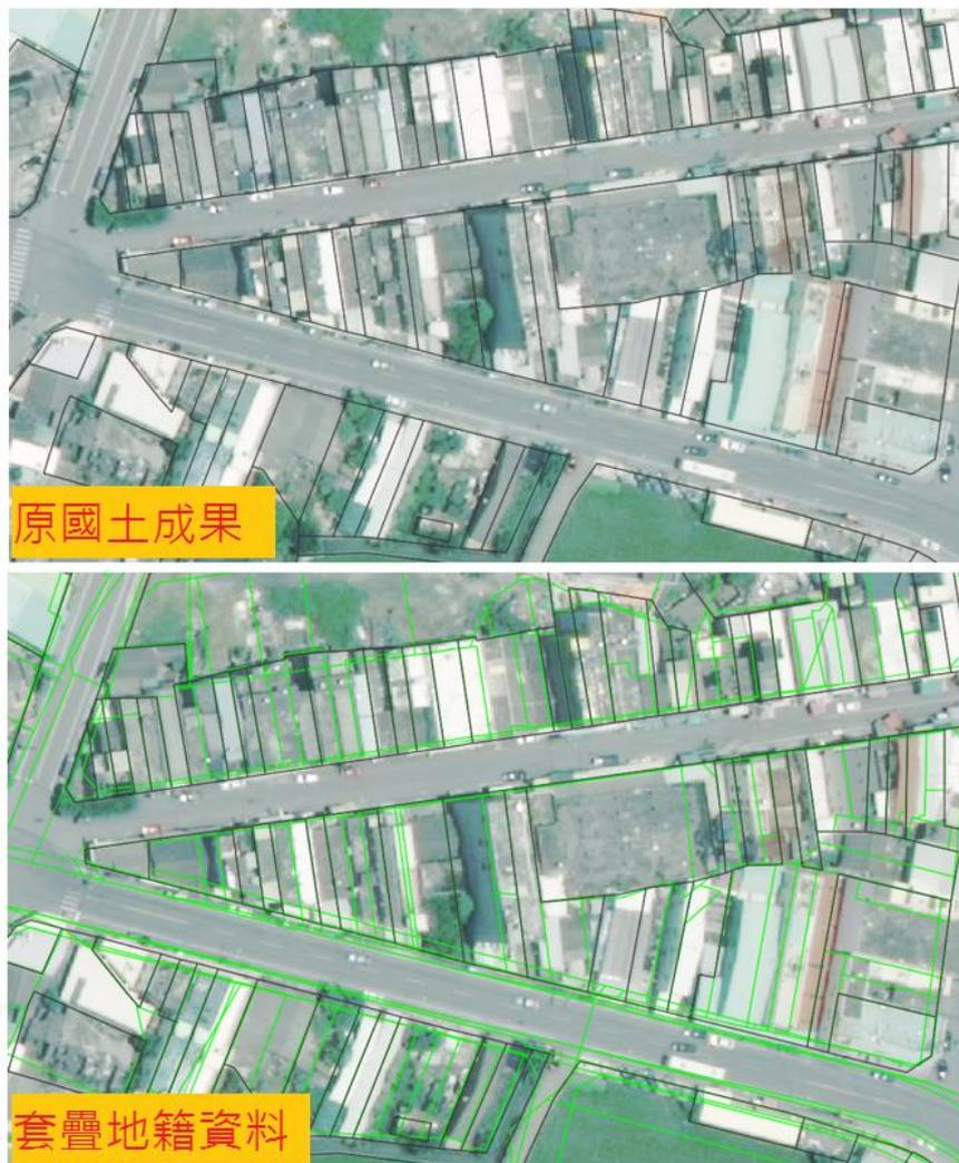
圖 3-24 地籍圖與電子地圖套合處理
