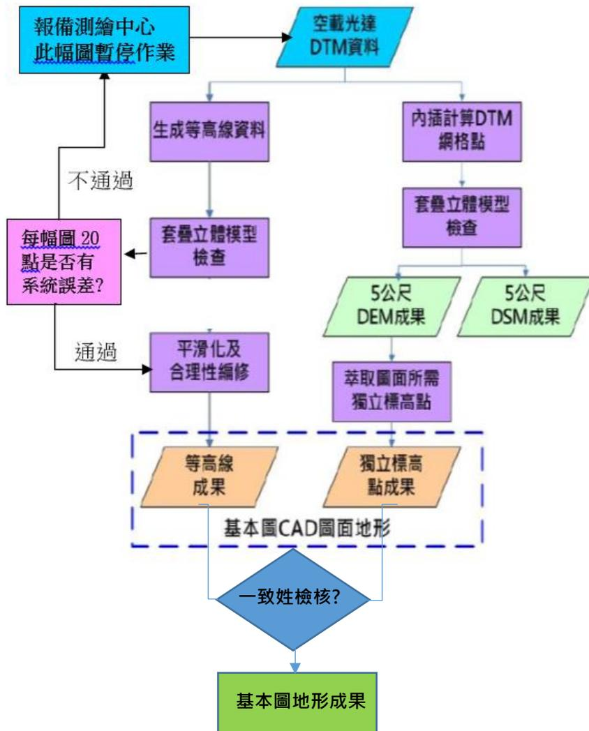
圖 2-7 光達 DTM 轉製地形及等高線作業流程圖
