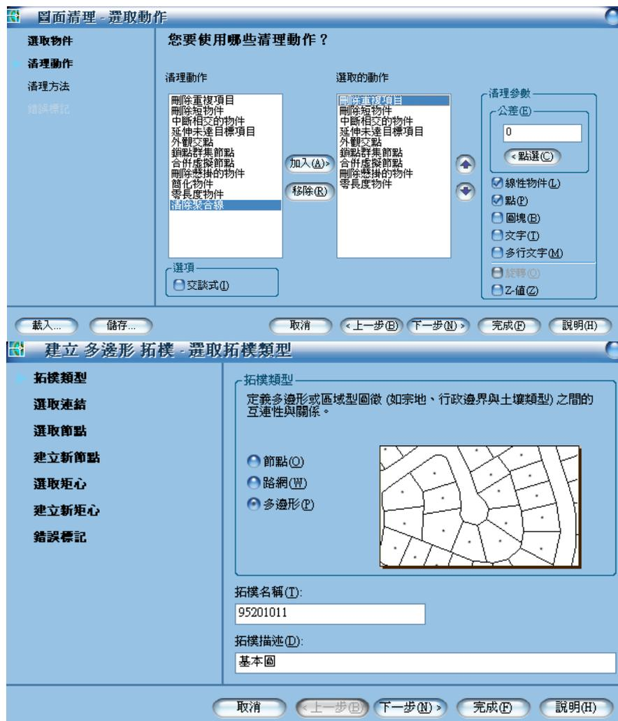
圖 2-18 AUTOCAD MAP 圖面清理及拓樸建立功能
