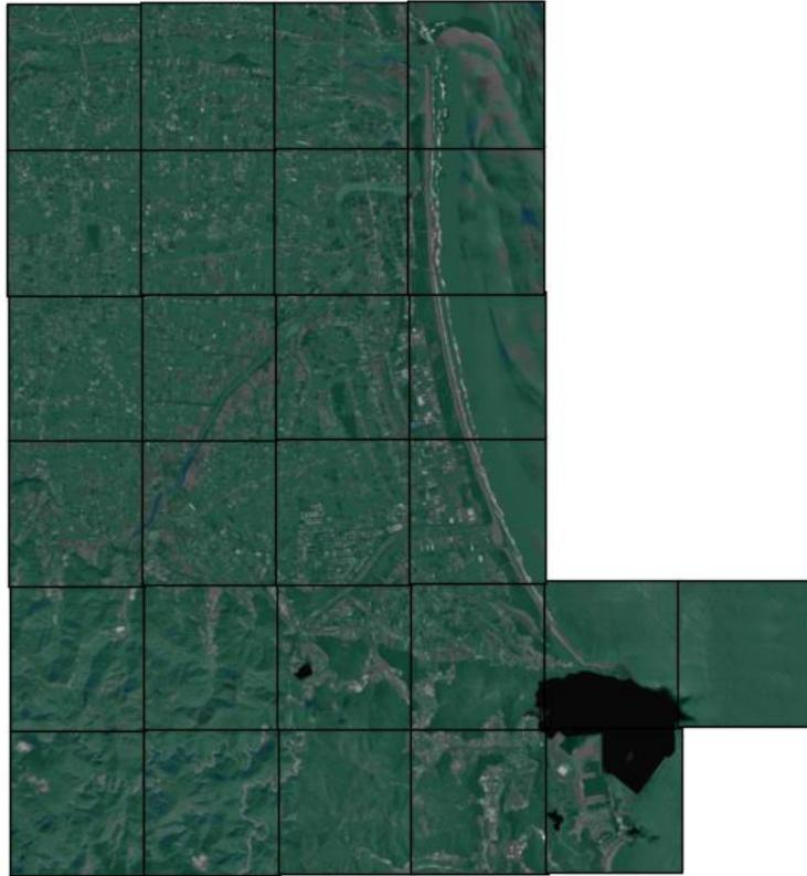
圖 2-13 106 年度正射影像無接縫影像拼接示意圖
