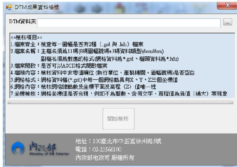
圖 2-9 內政部 DTM 網格檢核程式
