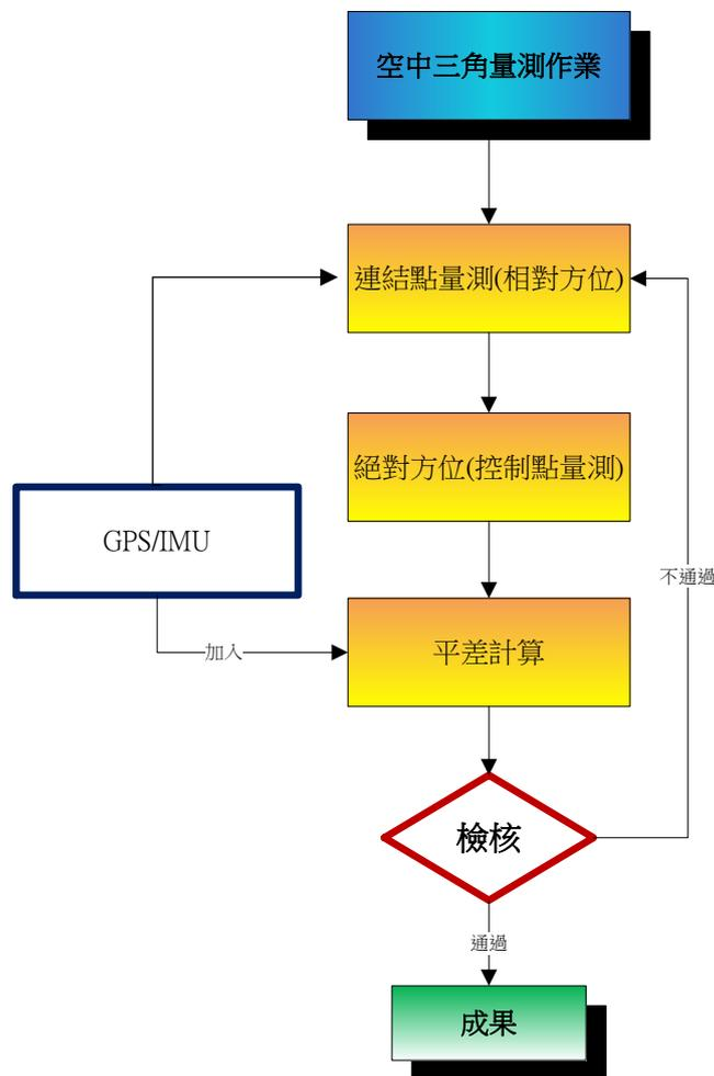
圖 2-3 空中三角測量工作流程
