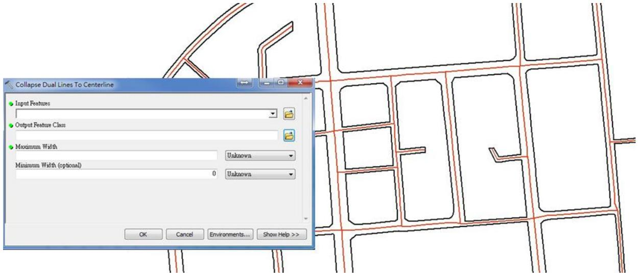
圖 2-19 路網與流域中線產製示意
