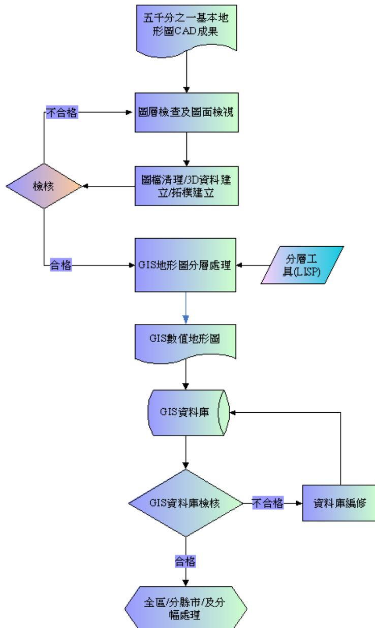
圖 2-17 五十分之一基本地形圖轉置 GIS 地理資訊圖層流程圖
