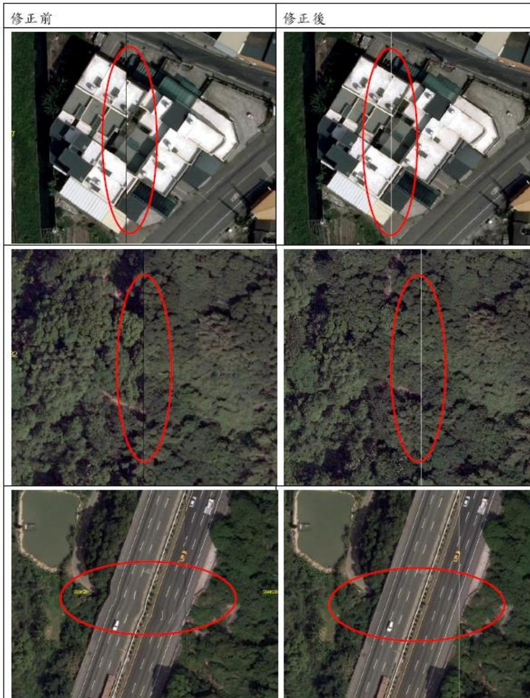
圖 3-4 正射影像接邊及變形自我檢核
