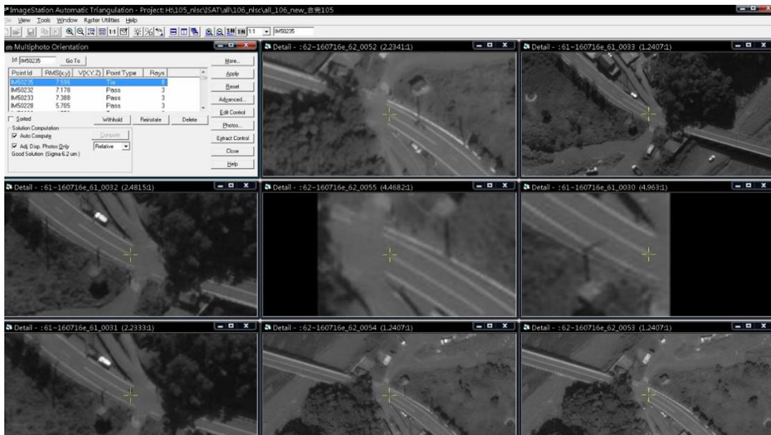
圖 2-4 像片坐標量測工作畫面示意圖
