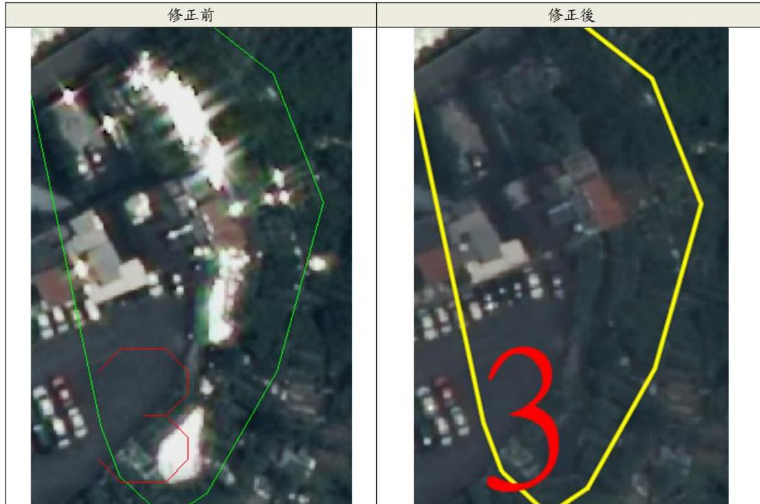
圖 3-5 正射影像曝光過度區域檢核修正圖
