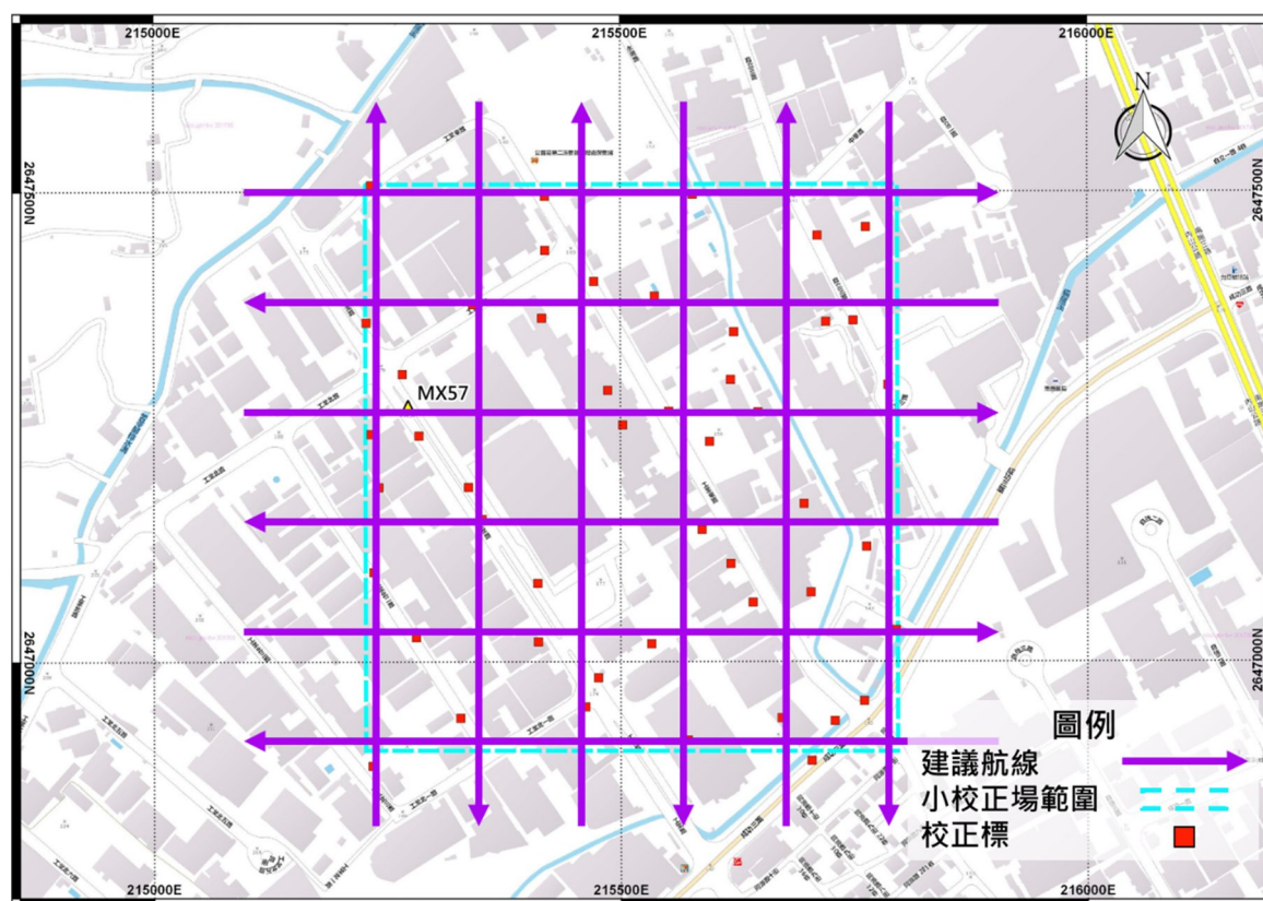
圖 4-2 小像幅校正航拍建議航線規劃 ( Sony A7+35mm )
