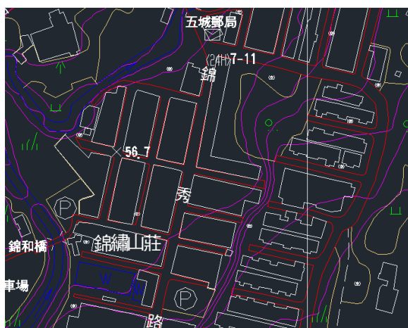
(a) 穿越建物—編修前
