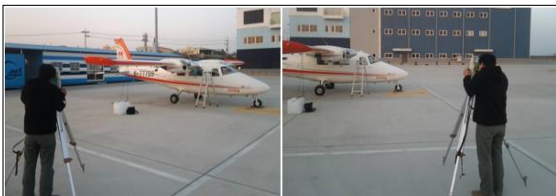
圖 2-11 Lever arm 量測作業照
