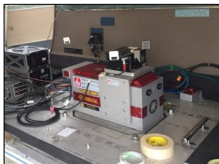
圖 2-2 空載光達 Riegl LMS-Q780 實機照
