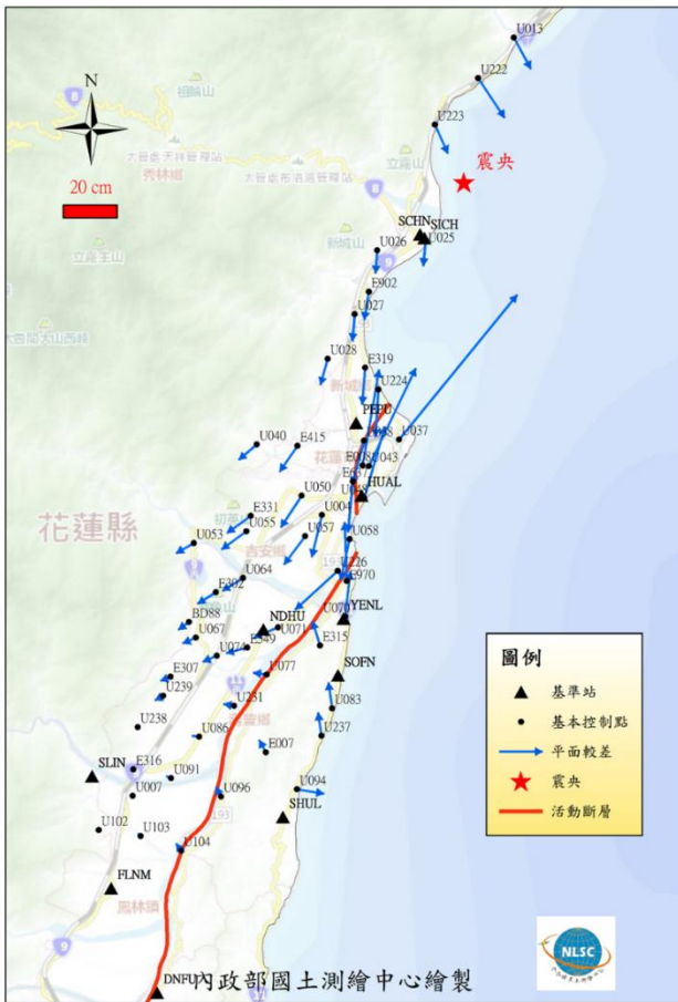
圖 3- 7 檢測成果與公告成果平面及高程分量較差示意圖
