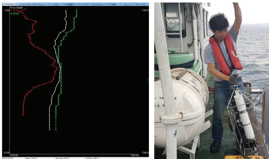
圖 3- 10 水下聲速變化剖面及現場作業照片
