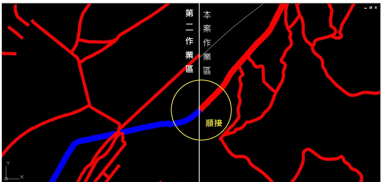
圖 3- 31 與第二作業區道路接邊情形
