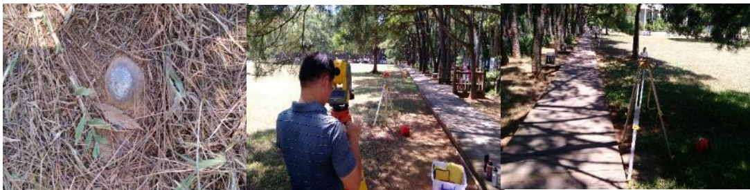
圖 4 桃園市中央大學簡易基線場及基樁配置
