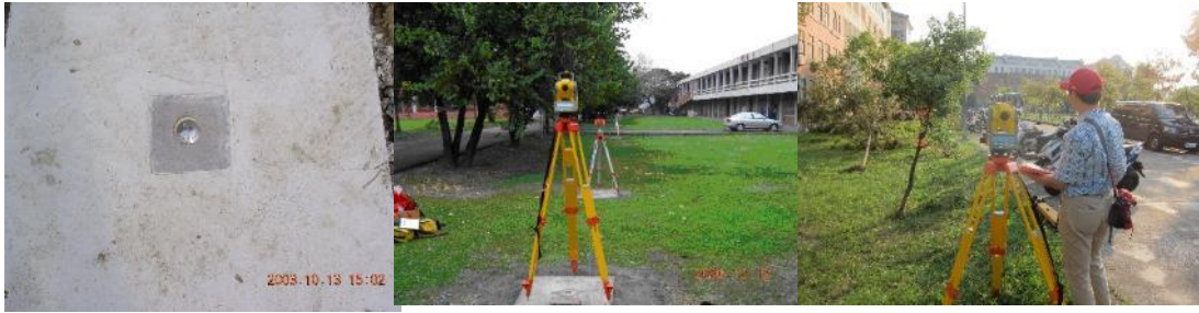
圖 2 本中心簡易電子測距基線場
