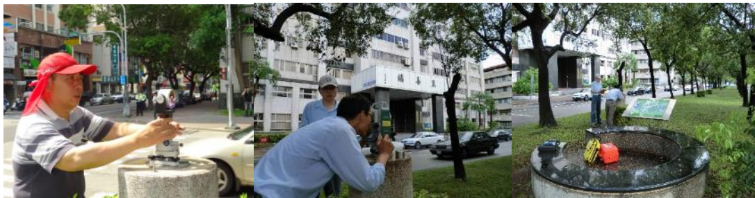
圖 1 本中心固定基座電子測距基線場及基樁配置
