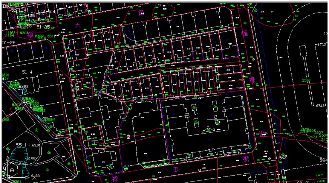
圖 2-8 第 1 區地籍圖與地形圖初步套合
