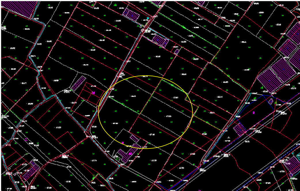
圖 3-34 第 3 區點對點三參數轉換後圖解數化地籍圖套合地形圖
