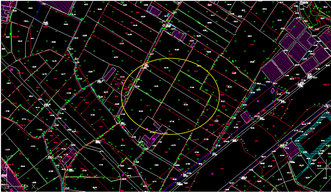
圖 3-25 第 3 區點對點六參數轉換後圖解數化地籍圖套合地形圖
