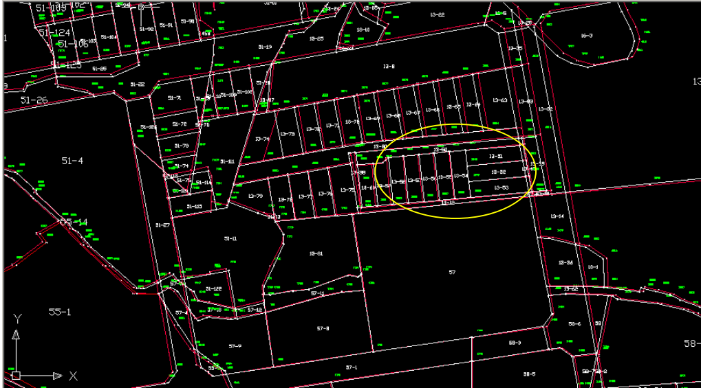
圖 3-9 第 1 區局部區域點對點六參數轉換後圖解數化地籍圖套合重測後地籍圖
