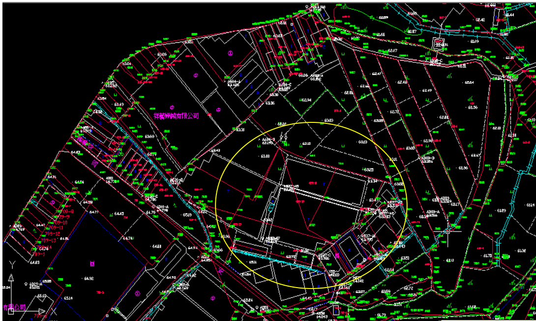
圖 3-21 第 2 區點對點四參數轉換後圖解數化地籍圖套合地形圖
