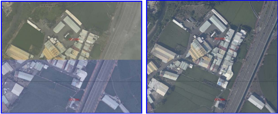
圖 5-12 左圖為不同時間點既有影像接幅問題，右圖為相同區域光達影像圖幅接合情形
