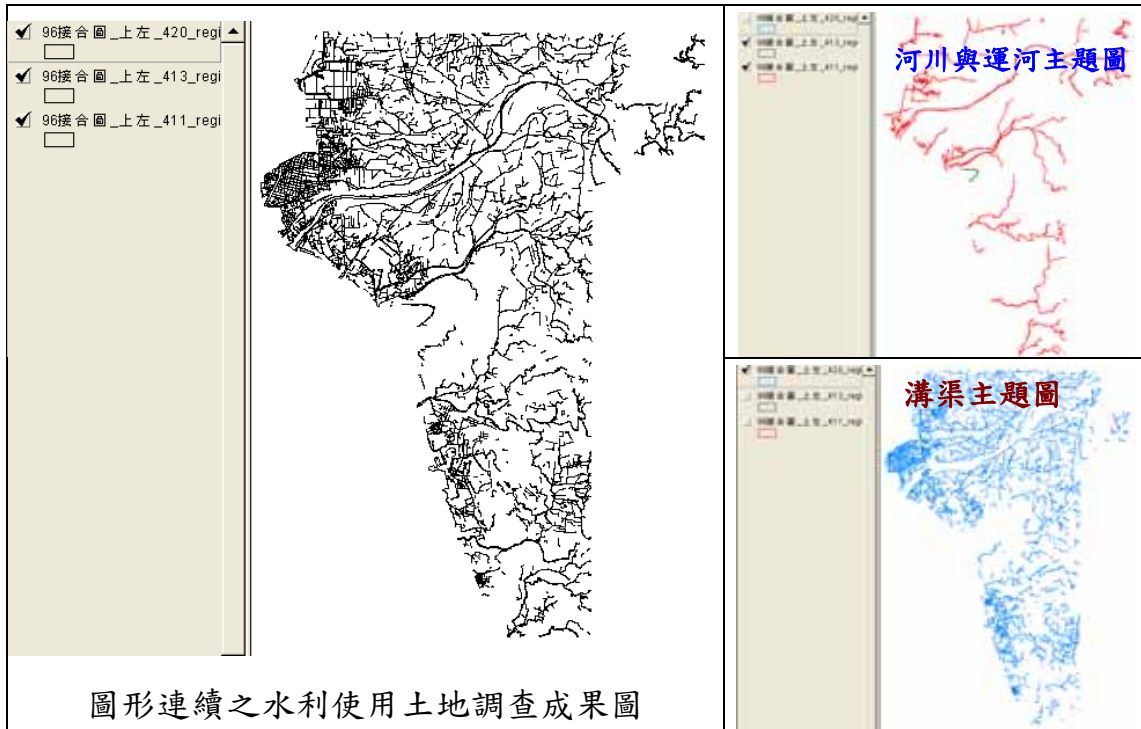
圖 4-1-7、水利使用土地之河流與溝渠抽出示意圖
