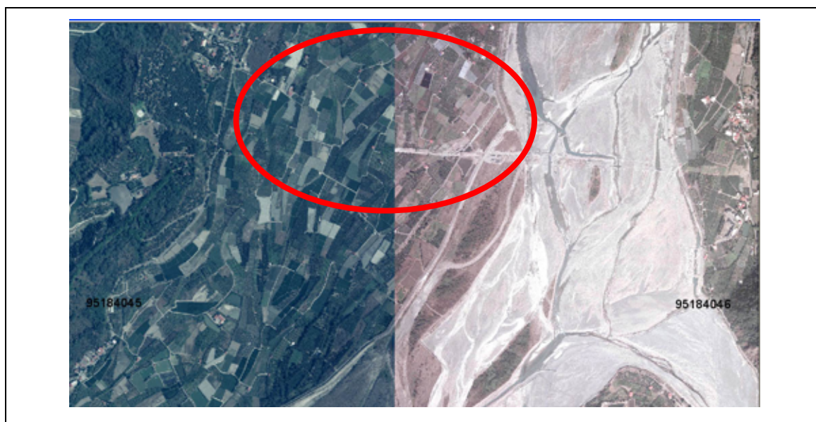
圖 4-1-2、95184045 與 95184046 相鄰圖幅不同年度接合成果圖
