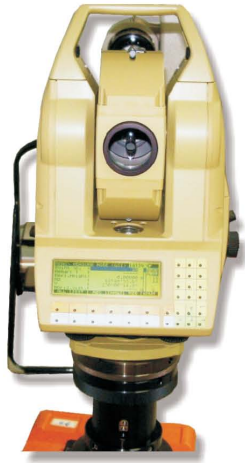
圖5-60 校正系統標準件 (精密電子測距經緯儀)
