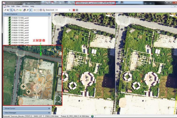
圖 2- 9 立體模型與正射影像不符檢查圖
