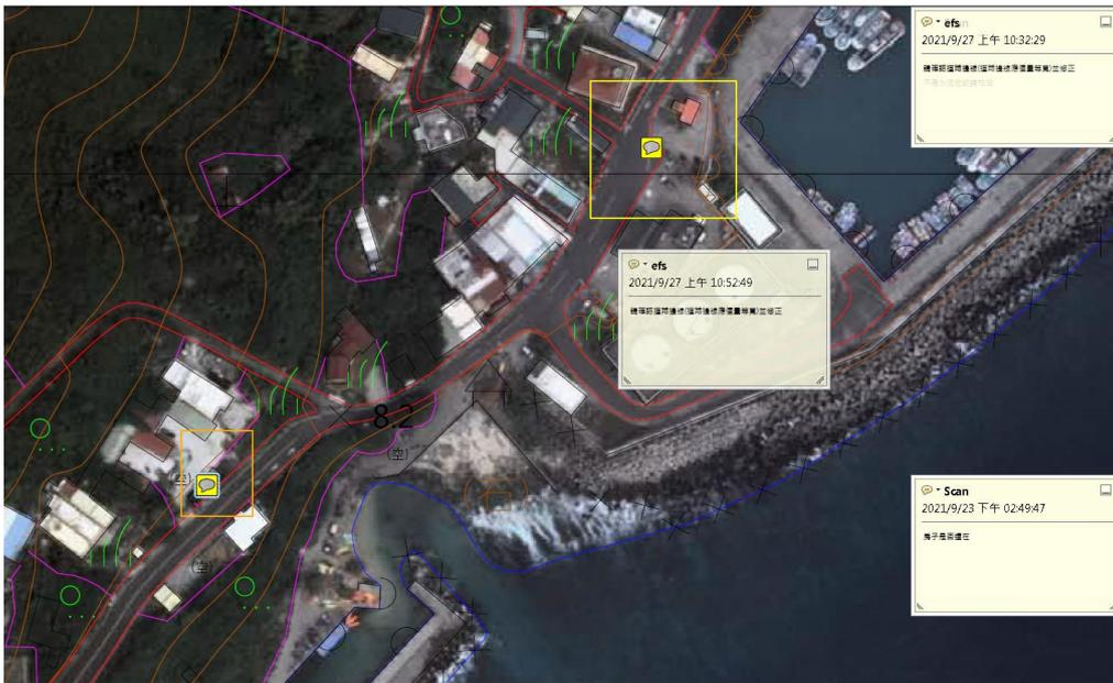
圖 2- 23 基本地形圖套疊正射影像檢查編纂圖
