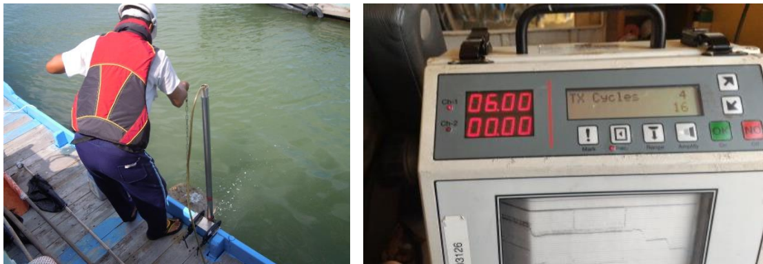
圖 3-87、Bar Check檢校情形
