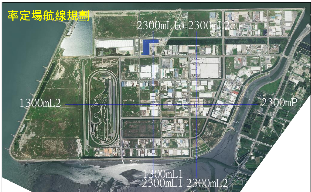
圖 3-65、空載光達率定場設置
