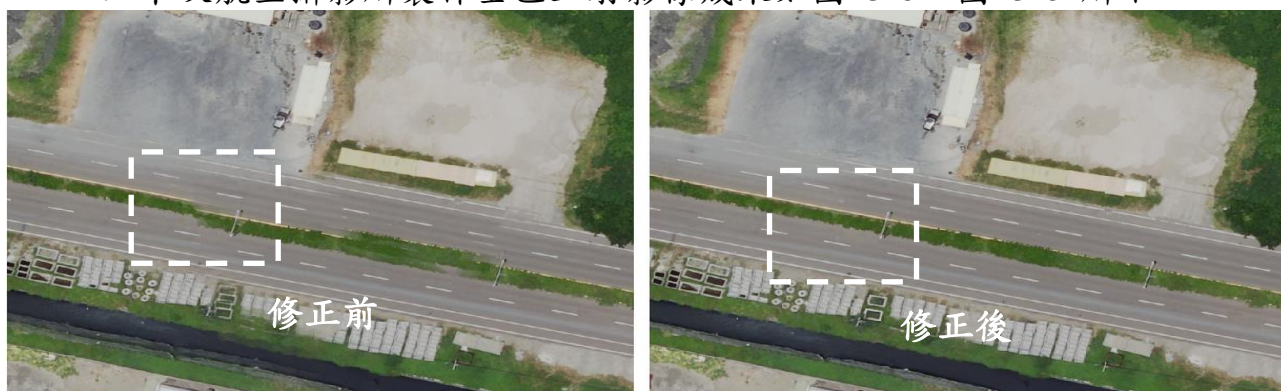
圖 3-59、正射影像接邊修正樣張
