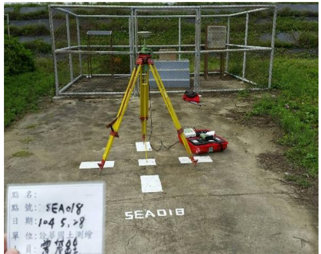
圖 3-44、航空標規格及實地布設情形
