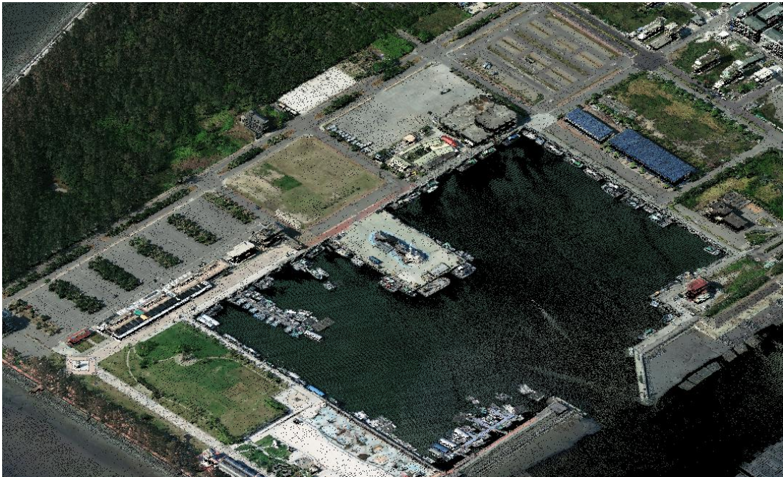
圖 3-79、東石漁港空載光達掃瞄彩色點雲圖
