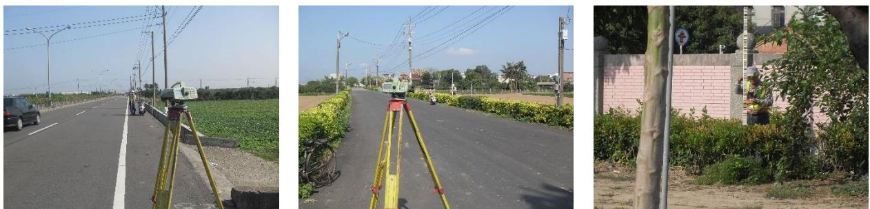
圖 3-7、水準測量作業情形
