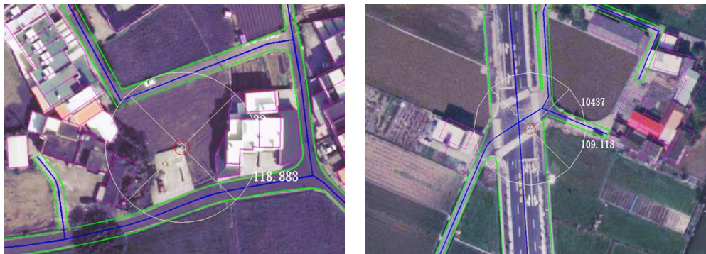
圖 4.6-5 以航測特徵點檢核正射影像範例
