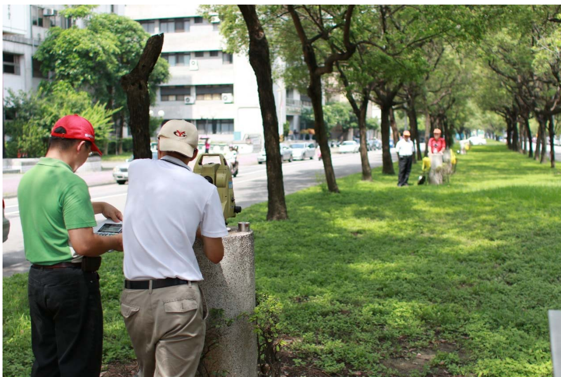
圖 3-2 固定基座基線場
