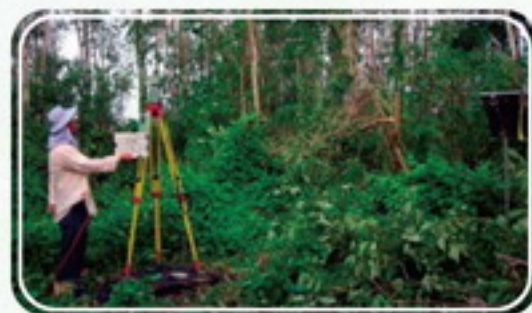
圖 4-1 三等精度控制點測量作業辦理情形
