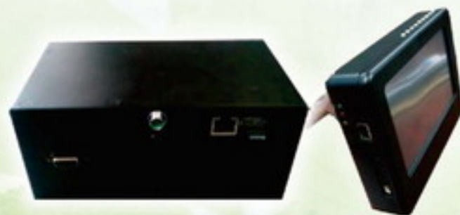
圖 4-65 使用者端多頻段差分修正訊號接收器及整合式定位系統操作平台
