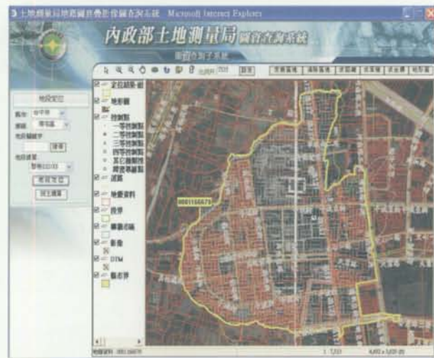
圖 4-8-2 圖資查詢系統-地段定位查詢畫面，套疊地籍圖、影像圖等圖資進行定位查詢。
