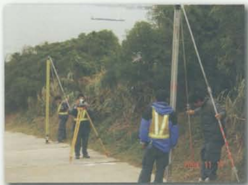
圖 4-1-9 馬祖地區精密水準測量 白天作業情形
