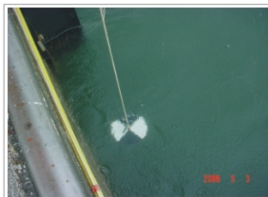
圖4-58 沙奇盤辦理海水透視度調查
