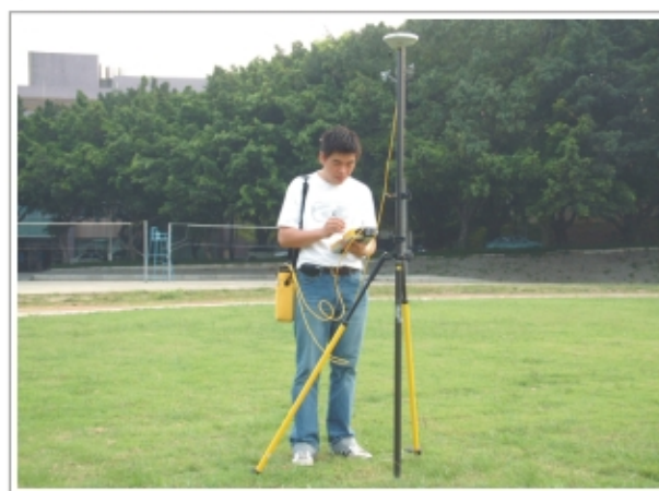
圖4-4 移動站VBS-RTK作業情形
