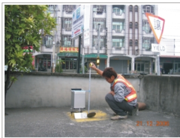
圖4-12 一等水準點上重力測量檢測工作情形
