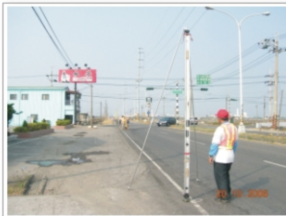
圖4-8 永安潮位站高程基準檢測工作情形
