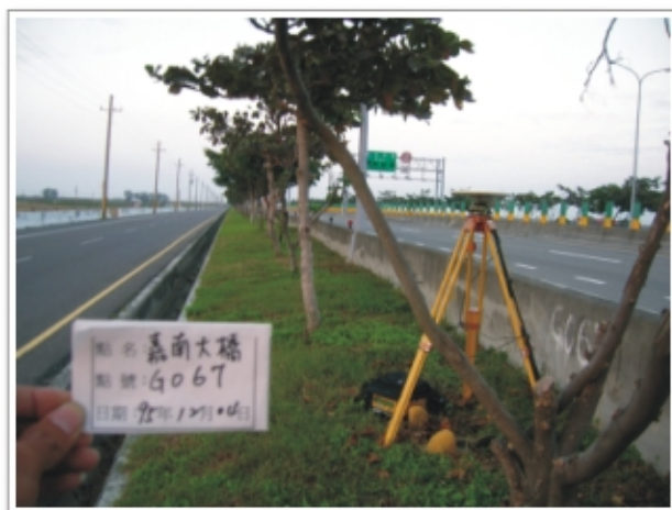
圖4-11 一等水準點上衛星定位測量檢測工作情形
