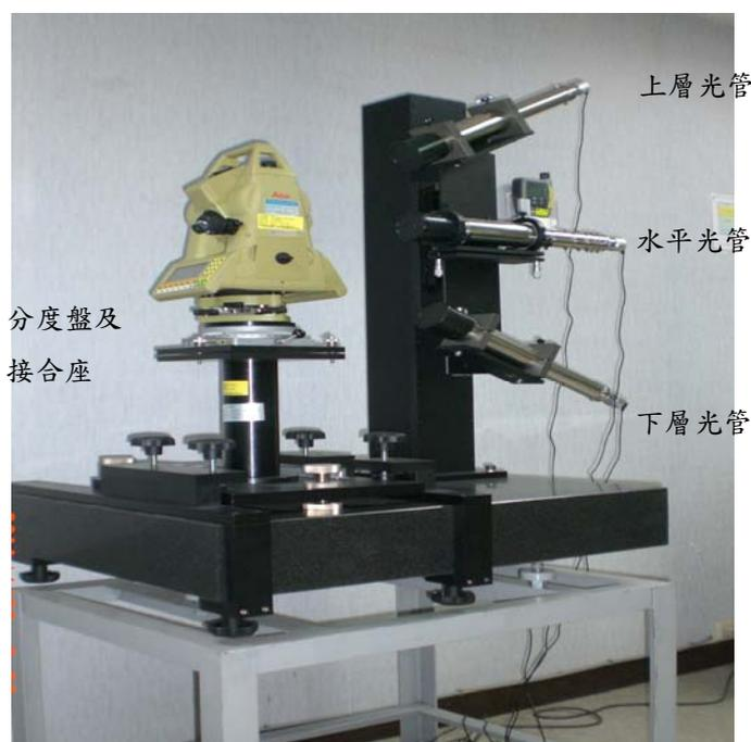
圖 2 分度盤校正系統架構示意圖
