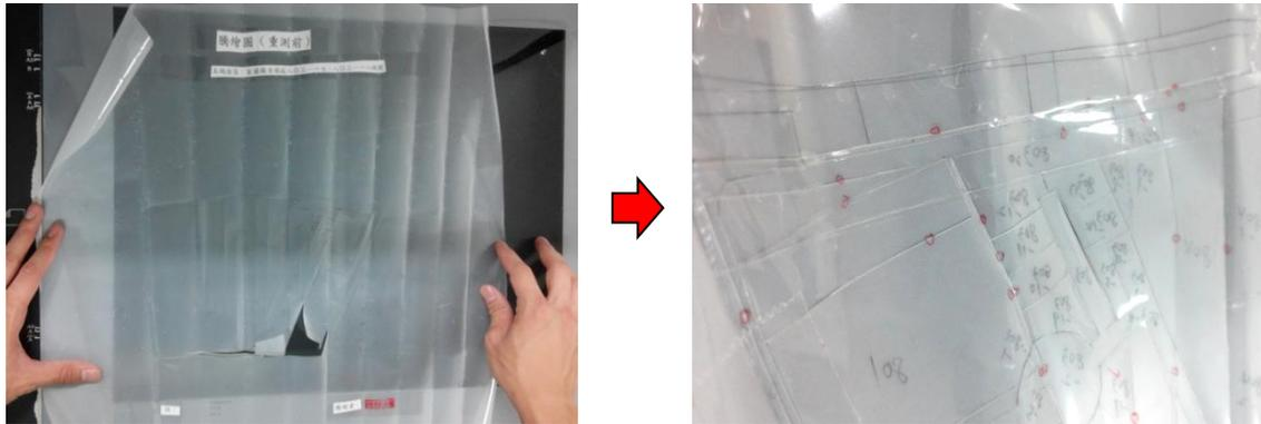
圖 4-20 謄繪圖膠片破損情形
