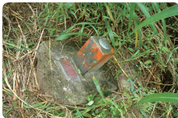
▲ 圖4-2 基本控制點檢測作業情形及點位毀損現況
