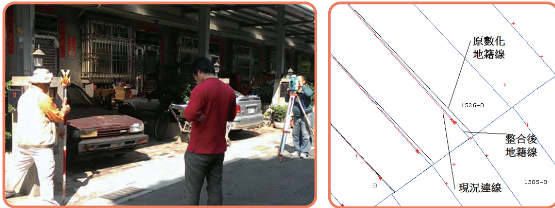
▲ 圖4-39 圖解數化整合建置地籍圖實地測量及土地經界線差異示意圖
