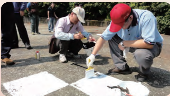
▲ 圖4-44 航測攝影機幾何校正標設置情形
