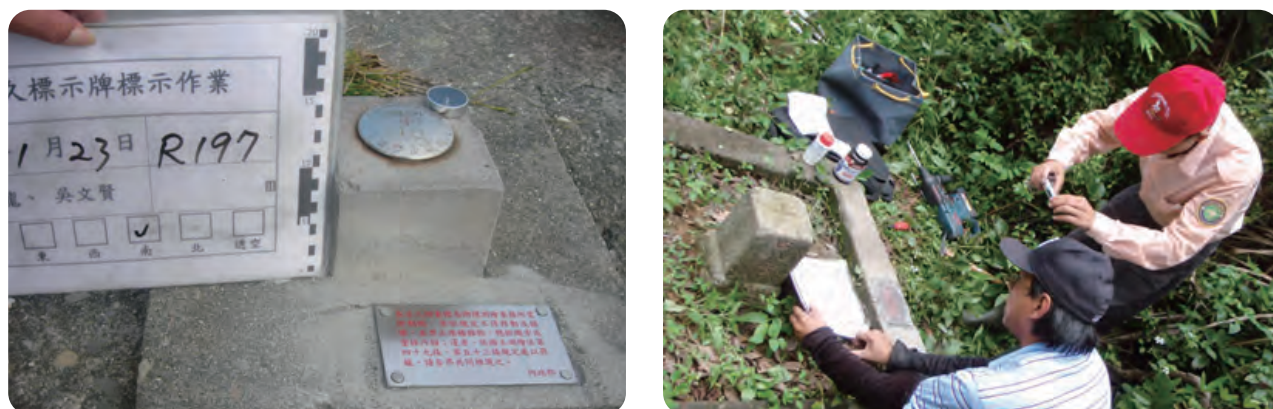
▲ 圖4-4 三等衛星控制點設置之標示牌及作業情形
