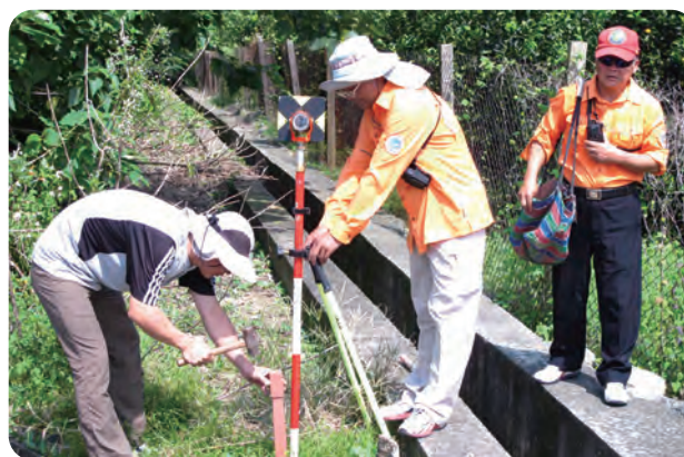
▲ 圖4-12 圖根測量(左)及協助指界(右)作業情形
