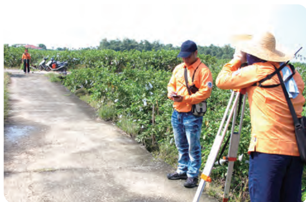
▲ 圖4-12 圖根測量(左)及協助指界(右)作業情形
