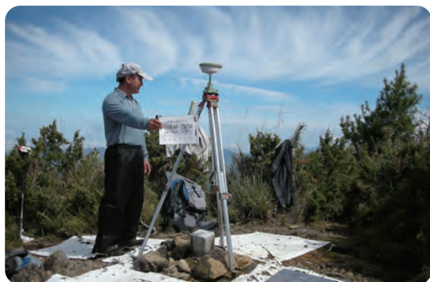
▲ 圖4-2 基本控制點檢測作業情形及點位毀損現況
