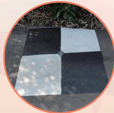
▲ 圖4-44 航測攝影機幾何校正標設置情形
