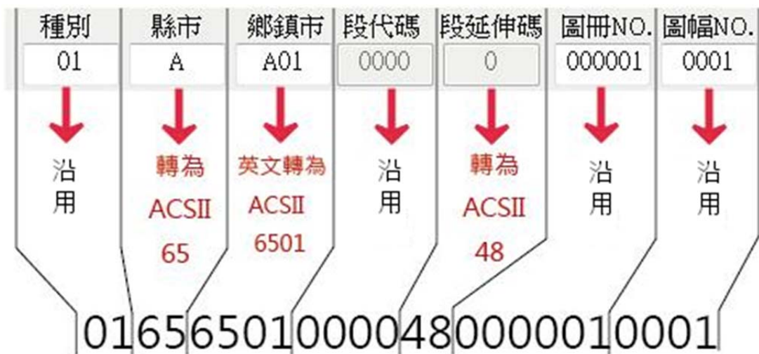
圖 3-26 影像檔名轉換 RFID UID 編碼示意圖
