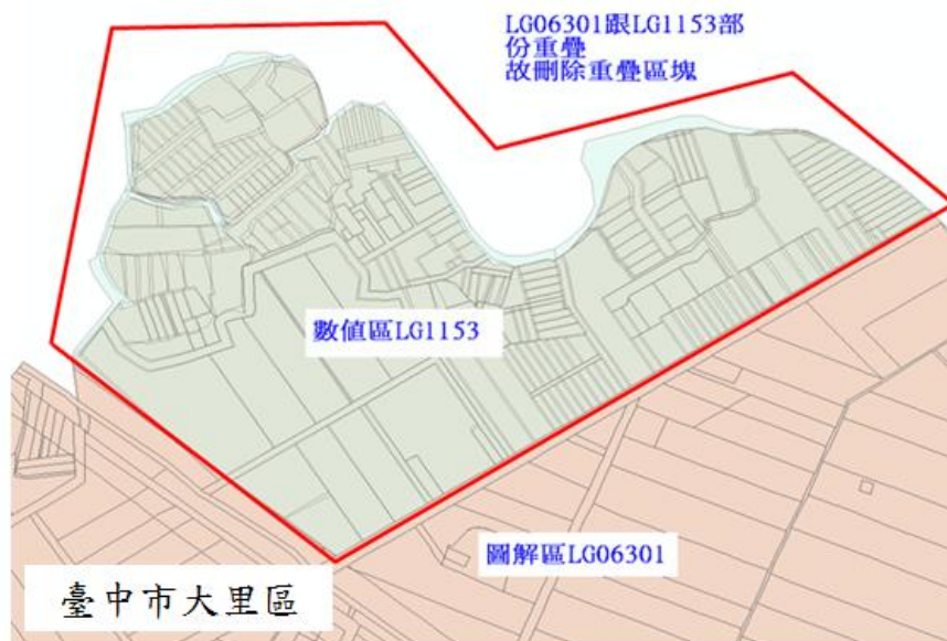
圖 4-99 重疊區域挖除原則（依測量方法）
