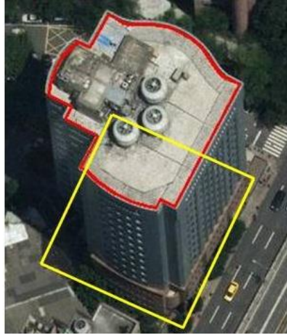
圖2-14、正射影像擷圖，黃色矩形表示建物輪廓地理座標換算成影像坐標所對應之範圍，紅色輪廓線為屋頂影像偵測結果
