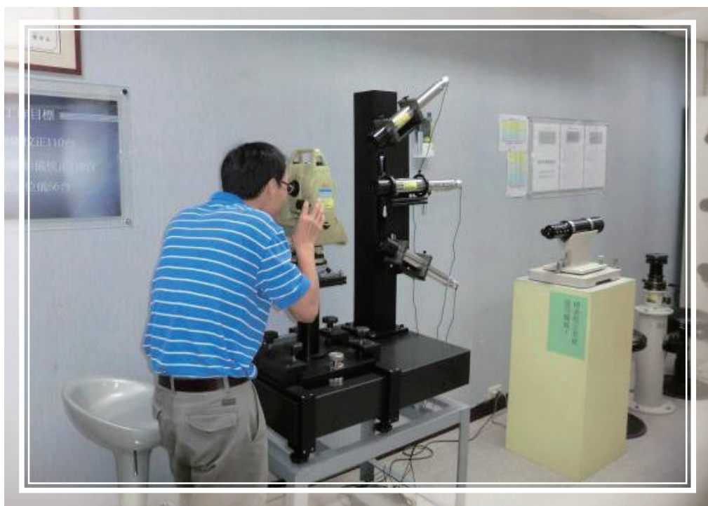
↑圖4-29 利用分度盤校正系統進行經緯儀校正作業
