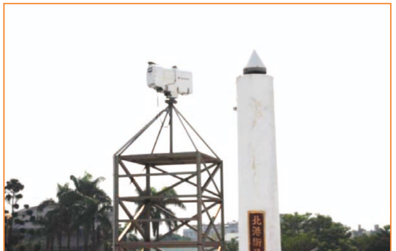
↑ 圖4-34 北港衛星追蹤站輻射計觀測情形
