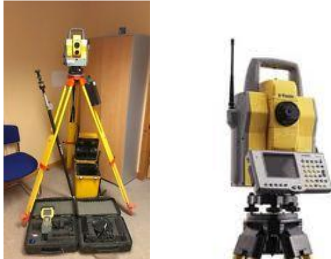
圖 3-25 TRIMBLE 5600IR 全測站儀（左）及控制面板（右）
