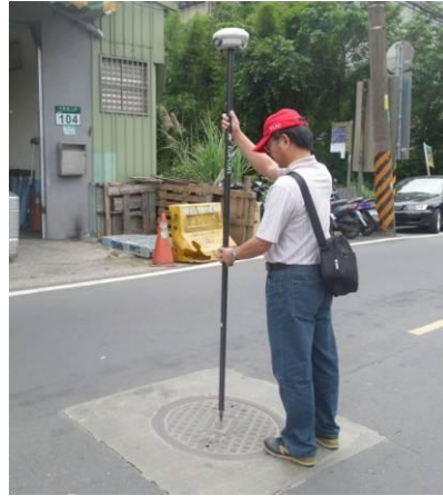
圖 3-47 Trimble R6 GNSS System 及其外業情形
