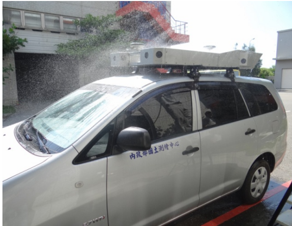
圖 3-82 防水測試現況照片 1
