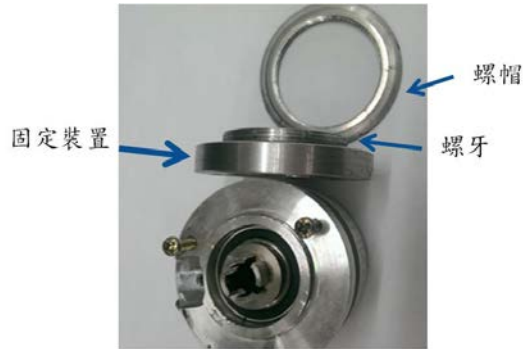
圖 3-10 輪速計固定裝置
