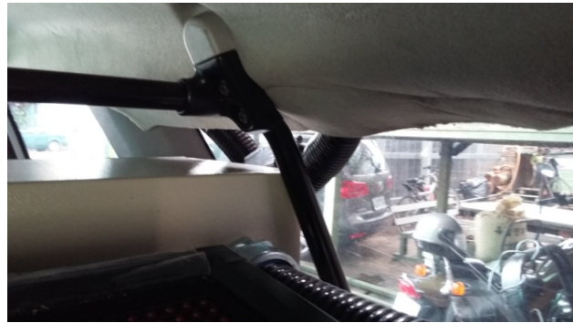
圖 3-81 線路由後方右側窗戶上方蓋板穿出
