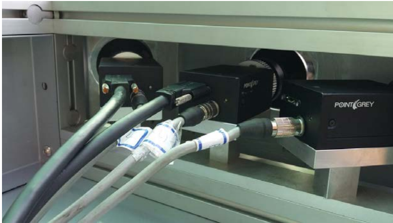
圖 3-107 MMS 相機連接線材
