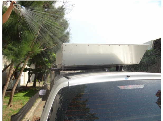
圖 3-83 防水測試現況照片 2
