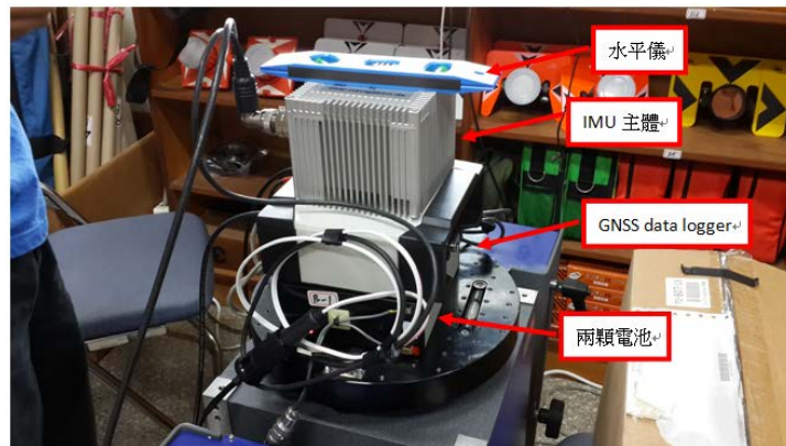
圖 4-13 慣性量測元件率定現況
