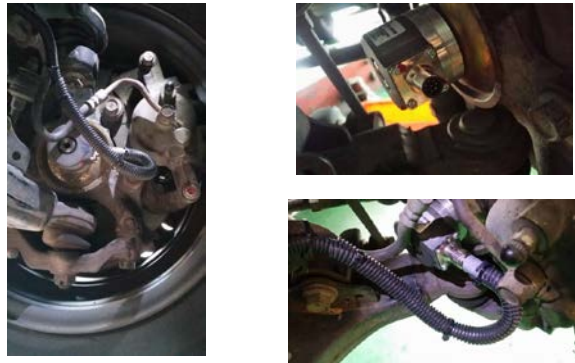
圖 3-7 輪速計改裝示意圖
