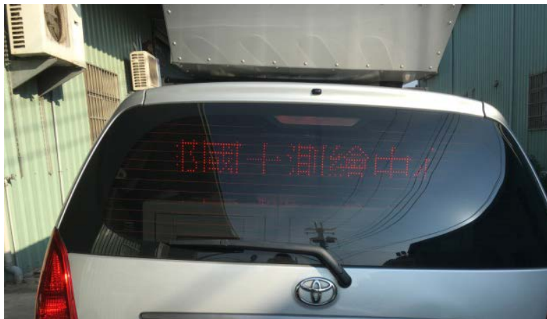
圖 3-103 車後警示裝置作業情形
