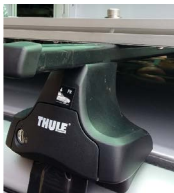
圖 3-68 設備平臺打釘鎖附於車頂架
