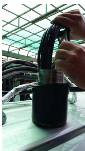
圖 3-110 線材塞入集線圓筒
