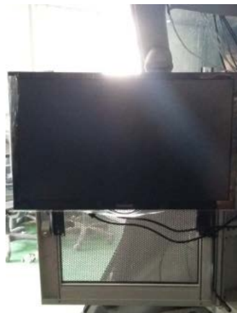
圖 3-91 螢幕可調整高度並可旋轉為橫向方便操作人員使用
