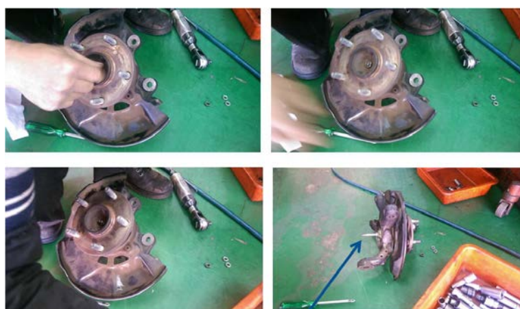
組裝新的傳動軸(較舊設計為長)
