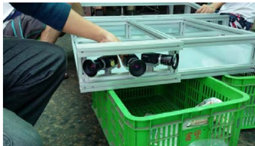
圖 3-72 設備平臺相機安裝狀況
