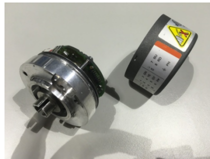
圖 3-9 輪速計外蓋及固定裝置
