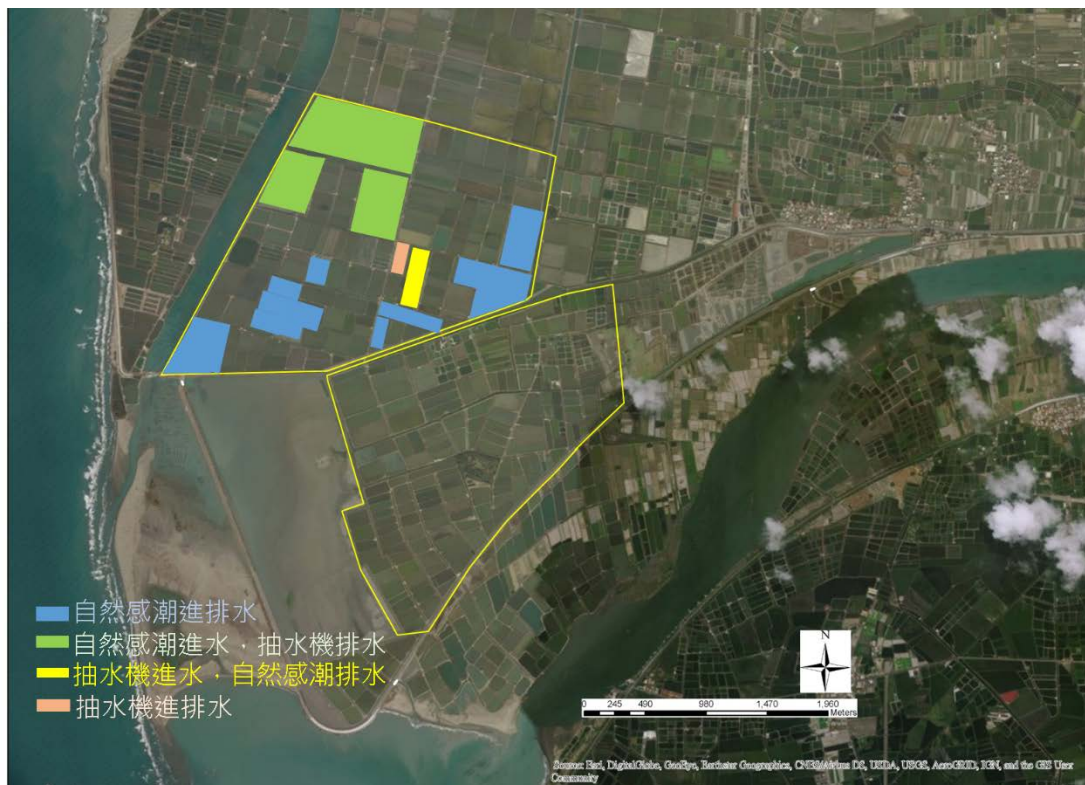
圖 3- 3 北魚塭養殖方式概況圖(依據本計畫現勘及訪談調查結果繪製)
