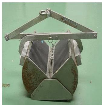
圖 3.4- 3 抓取式採樣器(Grab sampler)
