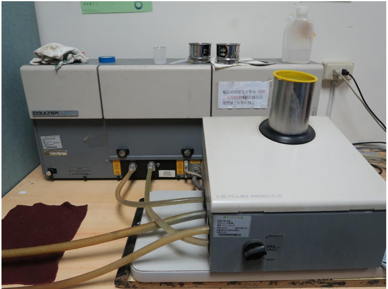
圖 2-4、本計畫底質粒徑分析所使用之 Counter LS-100 型雷射粒徑分析儀。
