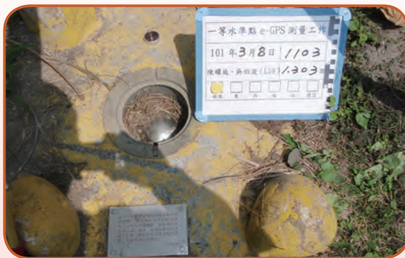
↑圖4-2 一等水準點e-GPS測量作業情形
