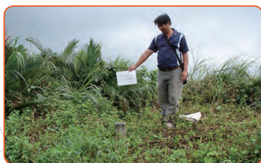
↑圖4-9 協助辦理控制測量已知點清查及圖根測量外業觀測情形
