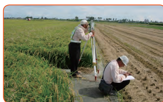
↑圖4-9 協助辦理控制測量已知點清查及圖根測量外業觀測情形
