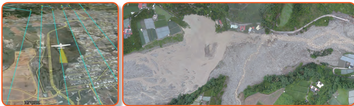
↑ 圖4-45 航拍即時監控(左)及南投縣和社溪堰塞湖影像快速拼接成果圖(右)
