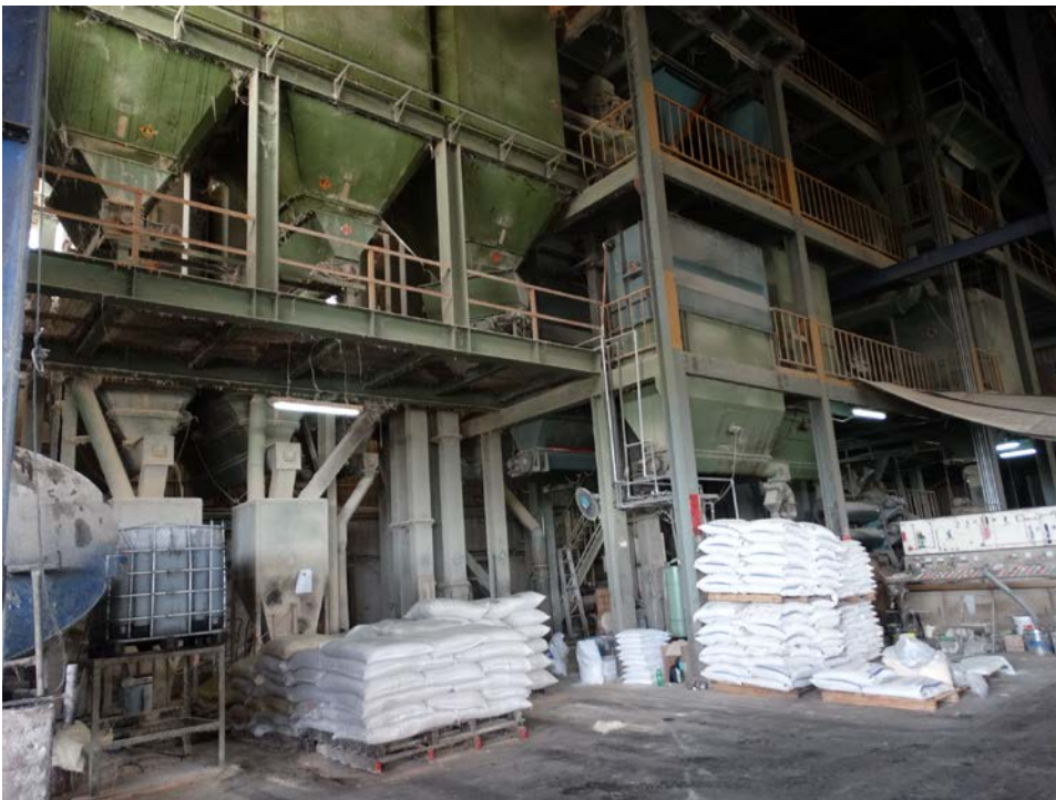
照片 41 飼料生產線全部自動化，原料成分比例均由電腦控制
