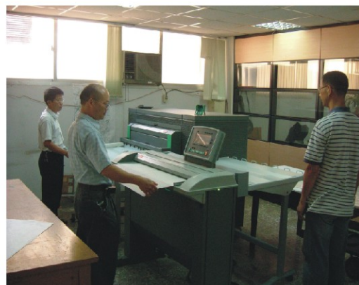
圖4-62 地籍藍曬圖曬製作業情形
