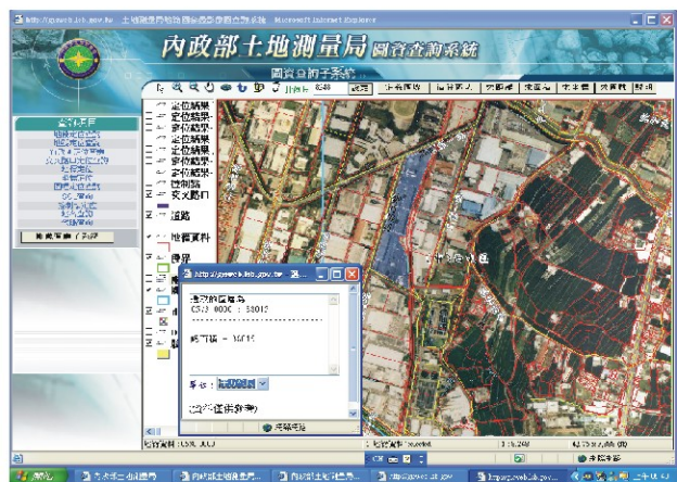
圖4-40 系統展繪地籍圖、正射影像及路網圖等資料，可以瞭解土地座落位置、面積及周圍使用情形（顯圖位置為臺中工業區）
