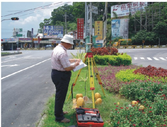
圖4-37 四等控制點GPS觀測外業實地 操作情形
