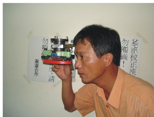
圖4-2 儀器基座檢校情形
