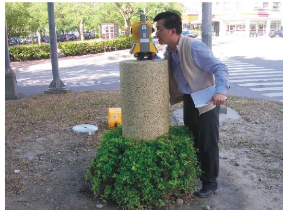
圖4-83 黎明固定基樁式基線場標準距離測量
