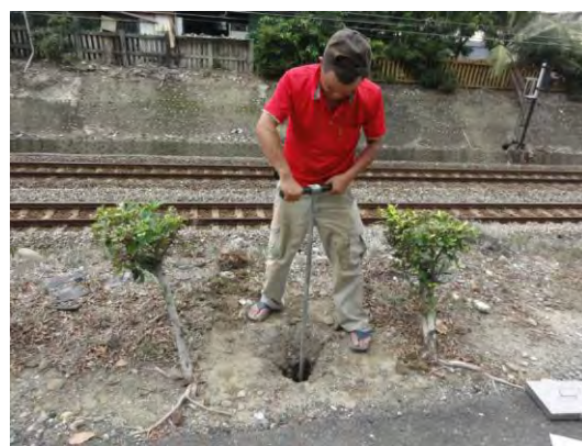
圖版 121 聖功女中人工鑽探工作照
