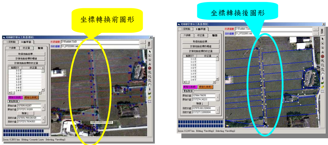
圖 2：地籍圖成果套疊像片基本圖調整之比較
