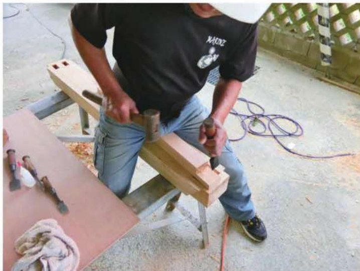
照片- 186：木製拖窗加工製作
