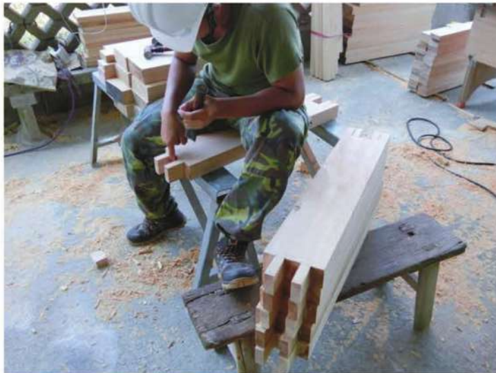
照片- 185：木製拖窗加工製作
