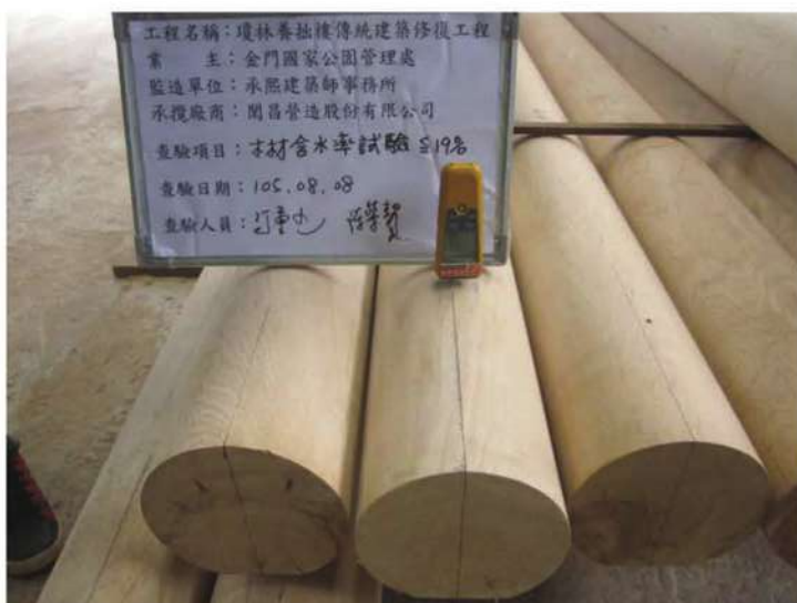
照片- 137：木料含水率檢測
