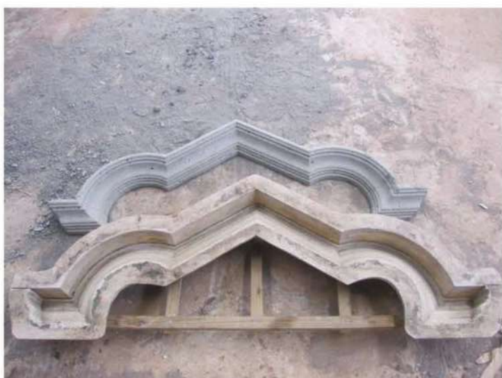
照片- 270：水泥預鑄窗簷線角及模具
