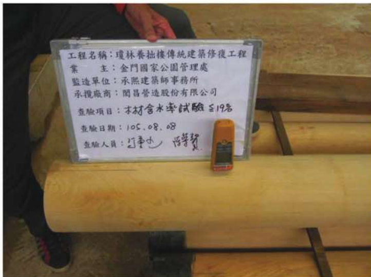
照片- 138 : 木料含水率檢測
