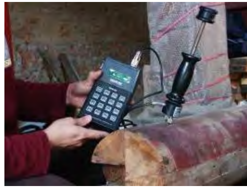
圖3-3 以含水率計量測木構件含水率
