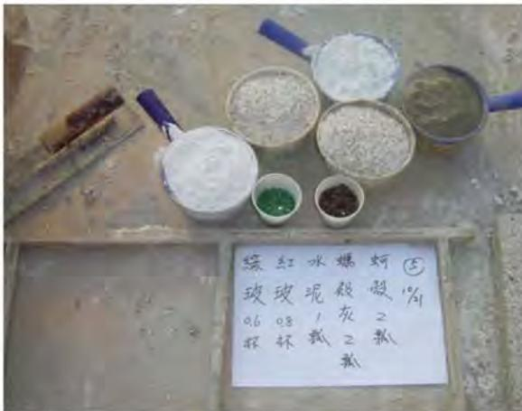
▲圖 6-70 三合土及灰砂漿製作材料
