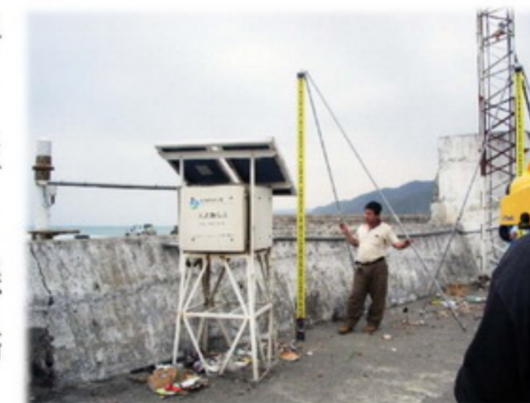
圖4-8 大武潮位站高程基準檢測工作情形
