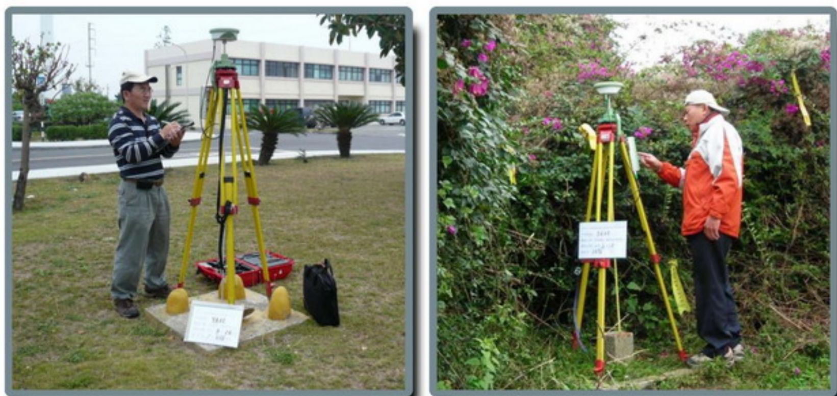
圖4-11 四等控制測量GPS觀測外業實地操作情形
