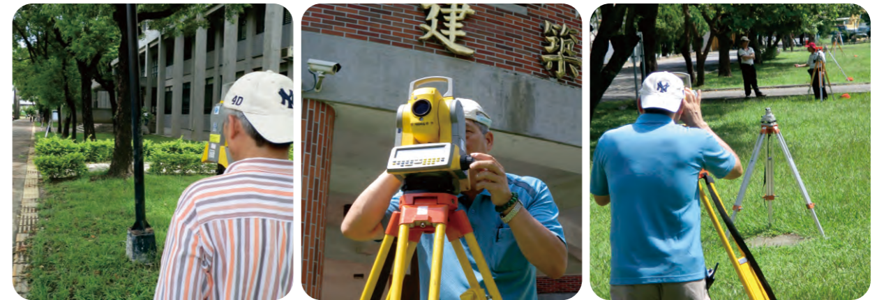
▲ 圖 4-57 簡易電子測距基線場檢測標準距離作業情形
