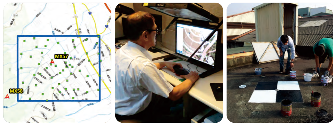
▲ 圖 4-59 航測攝影機校正場區及校正作業情形
