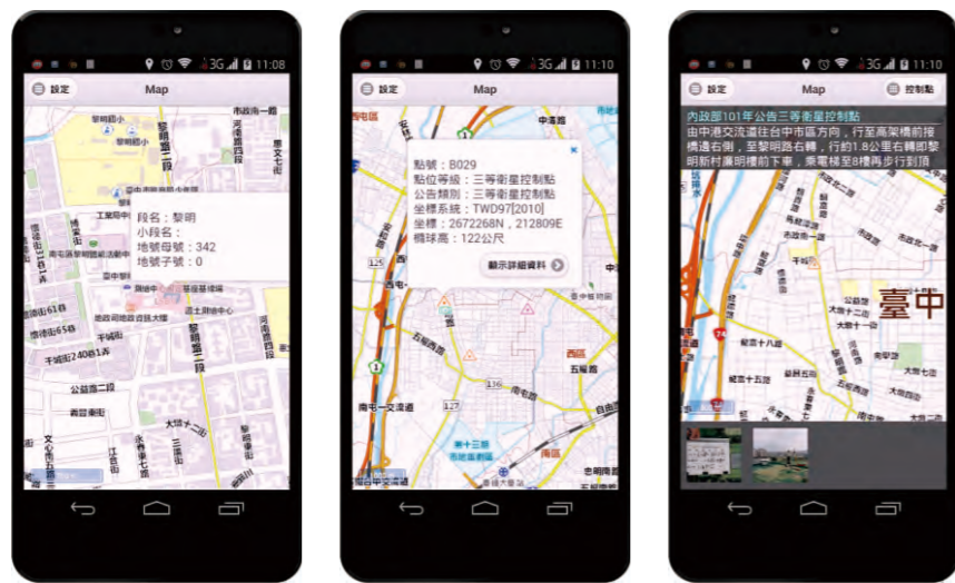
▲ 圖4-7 行動應用程式擷圖：地號查詢結果(左)、基本控制點查詢結果(中、右)
