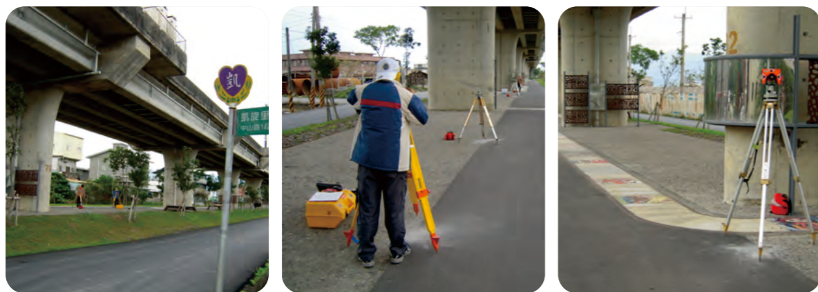
▲ 圖 4-54 新建之宜蘭簡易電子測距基線場檢測標準距離作業情形
