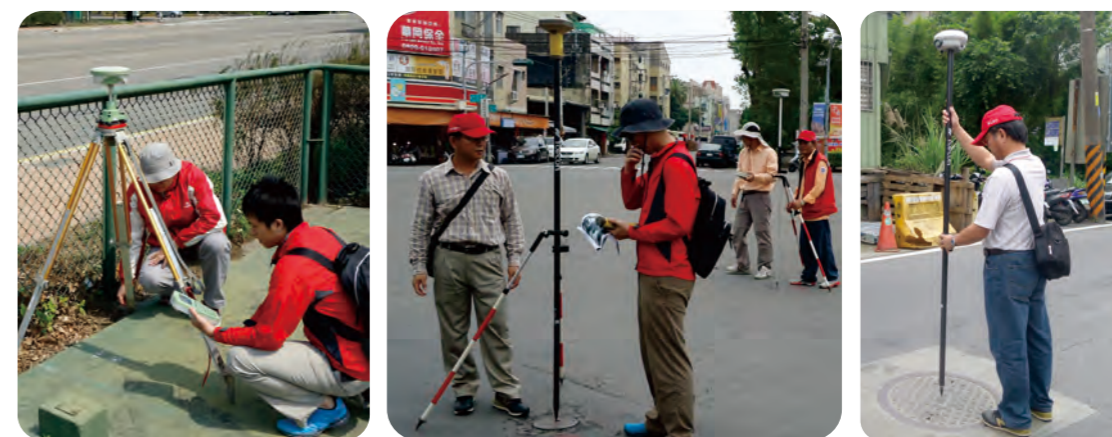
▲ 圖 4-53 e-GNSS即時動態定位系統進行管線孔蓋測量作業情形
