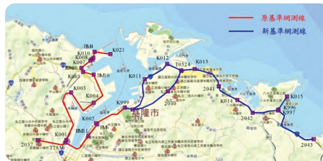
▲ 圖 4-3 臺灣水準原點高程基準網檢測路線示意圖
