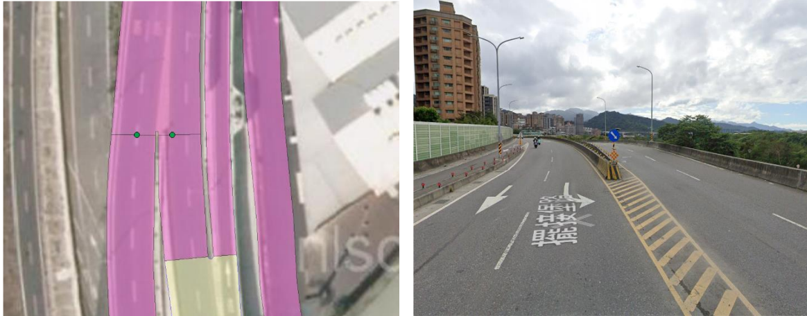
圖2-26 具高程變化之車向分流處切分案例
