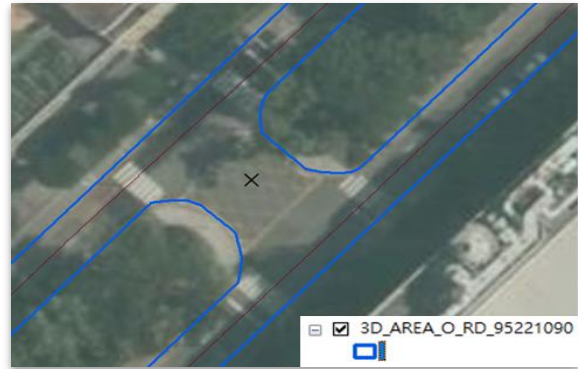
圖 2-24 具網狀線或槽化線的道路面
