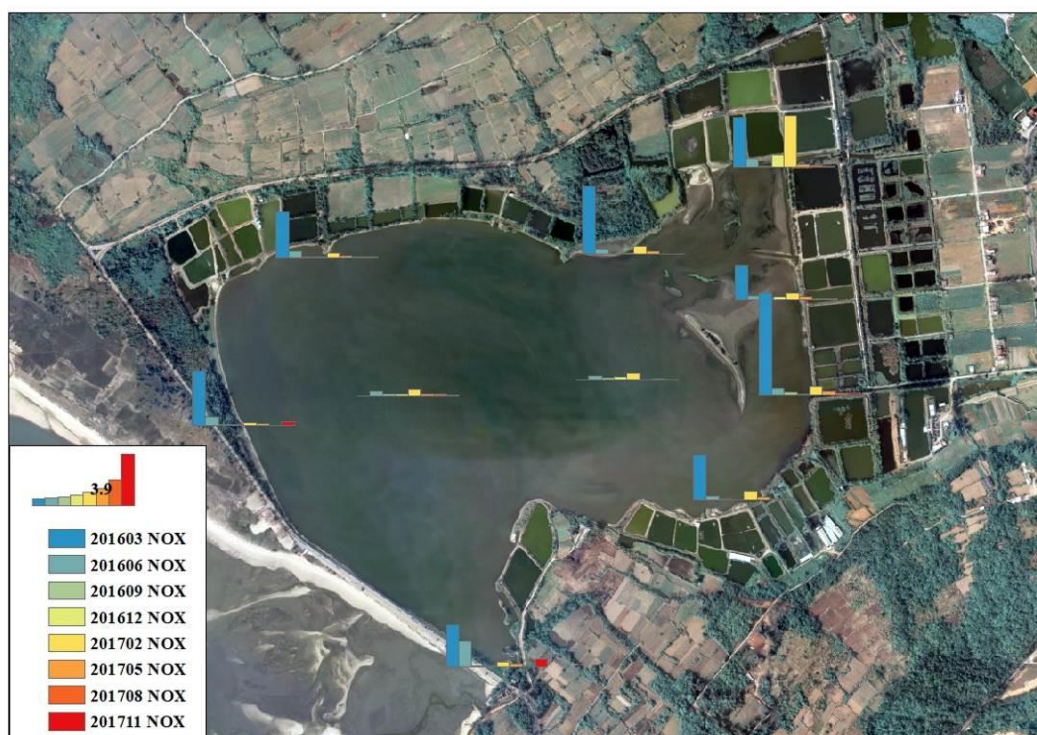
圖 3-2 2016 年 3 月至 2017 年 11 月慈湖 C1-C10 測站硝酸鹽濃度(mg L -1 )。圖示為相對基準值(資料來源：本研究)
