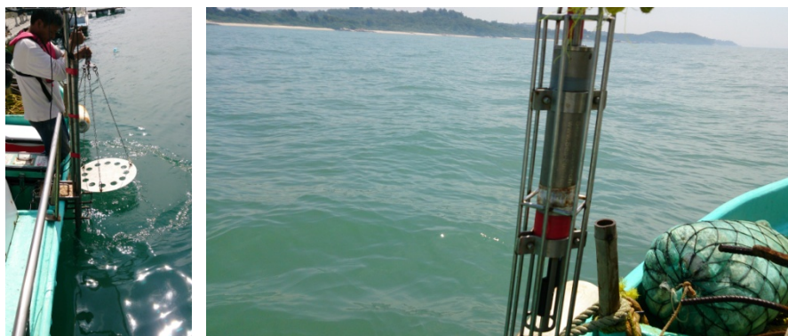
圖 4-71 單音束 Bar Check 檢校(圖左)及聲速剖面量測(圖右)情形
