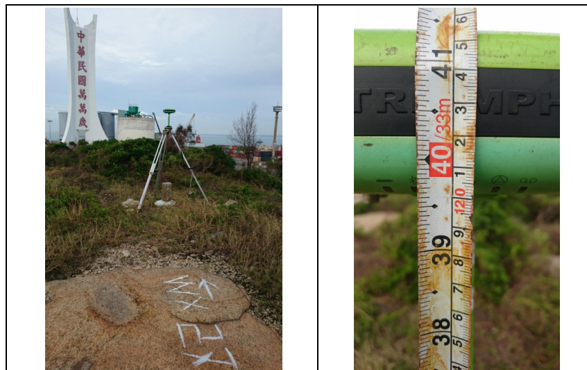
圖 4-74 水深測量 GNSS 固定站架設及天線高量測照片
