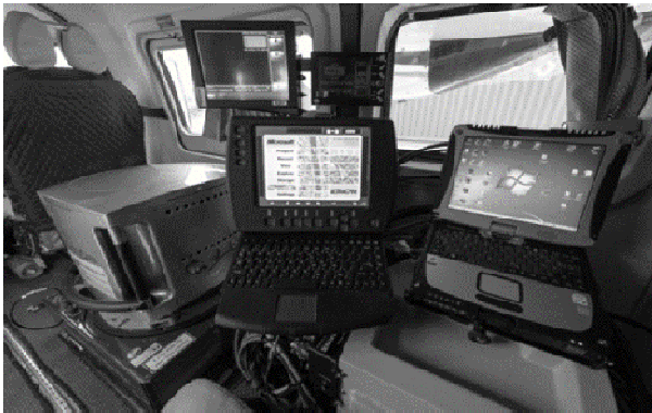
圖 4-49 航空專用數位式像機(UltraCam-Xp)實機照
