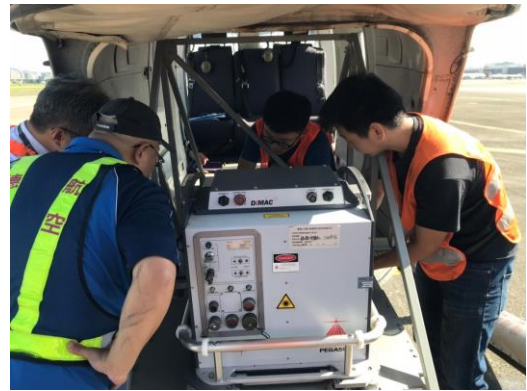
(b)ALTM 裝設於直升機之現況圖
