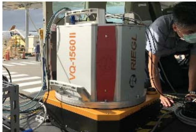
圖 4-10、光達儀器與航拍相機安裝
